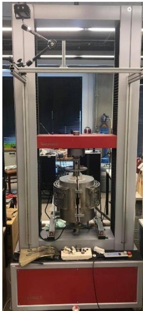
Obr. 31 Trhací stroj TESTOMETRIC FS100CT Zdroj: autor práce, 2021 (vlastní)
