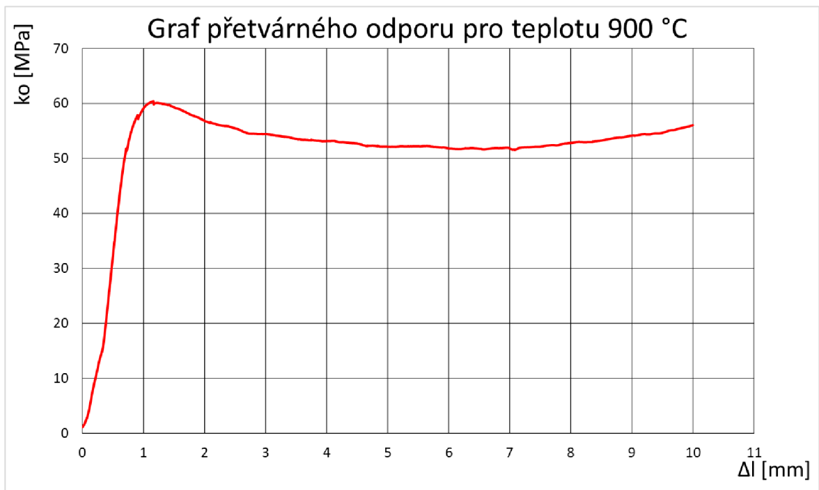
Obr. 51 Charakteristický průběh přetvárného odporu pro teplotu 900 °C
