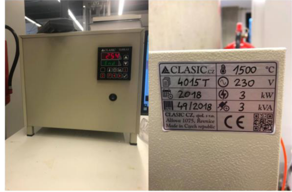
Obr. 33 Regulátor teploty a jeho štítkové údaje
