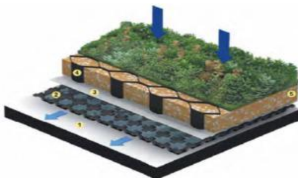
Obrázek 8: Systém vrstev – extenzivní zelená střecha (zdroj: RASUL, ARUTLA, 2020). (1) hydroizolační vrstva, (2) drenážní vrstva, (3) filtrační tkanina, (4) plastový zadržovací rošt, (5) substrát
