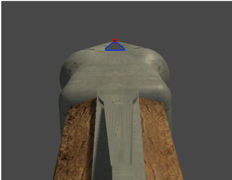
Obrázek 3.1: muška (červená), je posazena tak nízko, jak je to možné, aby zároveň byla současně viditelná celá plocha spoje mezi hlavněmi (modrá).
