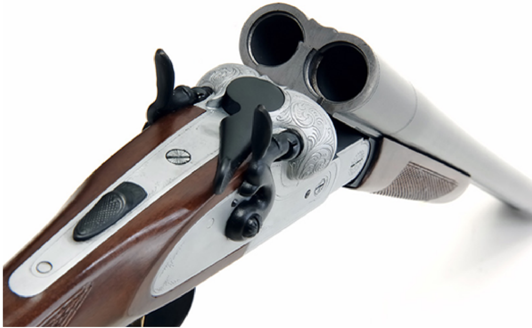
Obrázek 3.2: zlomená brokovnice lankasterka . Lze si povšimnout páčky za hlavní pootočené směrem doprava z kroku 1. A nalomené hlavně z kroku 2. 2
