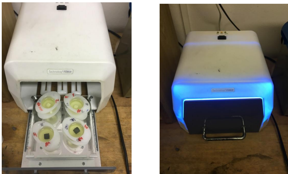
Obr. 6.4: UV pec s připravenými vzorky před vytvrzením (vlevo). Průběh vytvrzování vzorků (vpravo).
