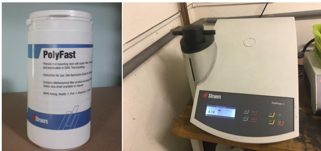
Obr. 6.2: Vlevo je materiál PolyFast a vpravo lis od firmy Struers.
