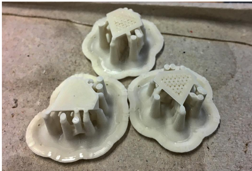
Obr. 7.3: Vzorky materiálu Vitrolite z SLA tiskárny.
