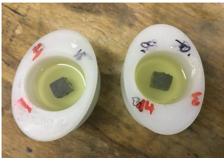
Obr. 7.12: Příprava vzorků C1 na výbrusy po sintraci na 1400°C - zalité pryskyřicí.
