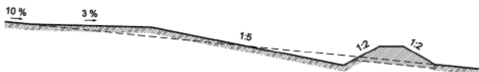
Obrázek 5: Příčný řez protierozní hrázkou (Janeček a kol. 2012)
