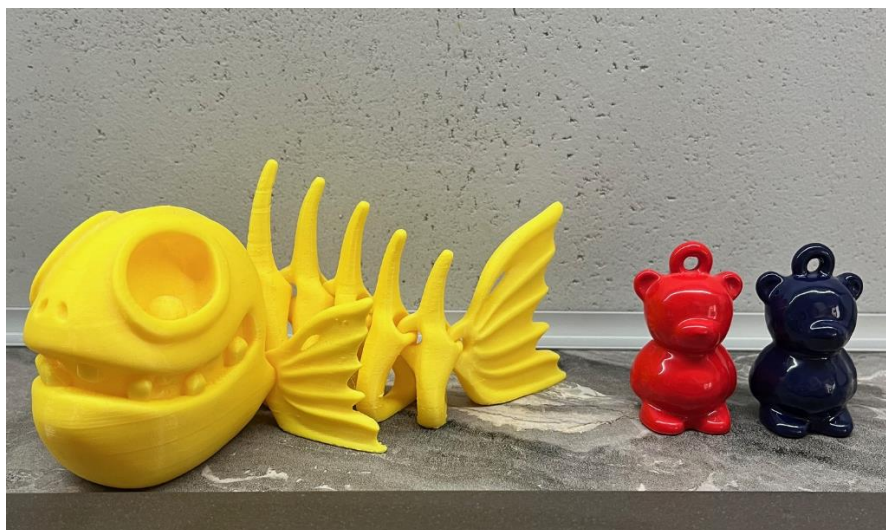
Obrázek 13 - Příklad produktů společnosti vyrobených pomocí metody FDM
