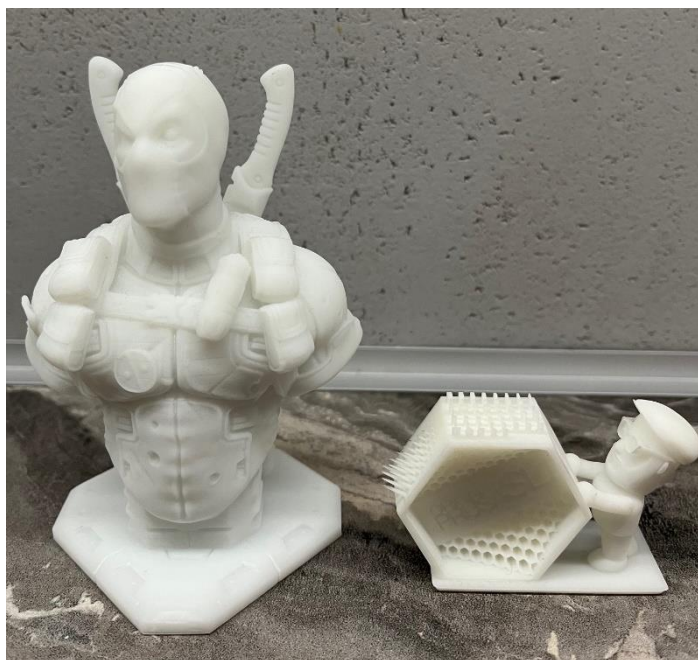
Obrázek 14 - Příklad produktů společnosti vyrobených pomocí metody SLA
