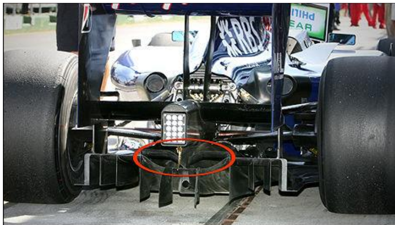
Obrázek 31: Kanál dvojitého difuzoru na voze stáje Williams [53]
