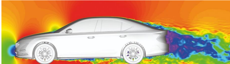
Obrázek 5: CFD simulace vozu Škoda Octavia liftback, rychlostní profil [7]
