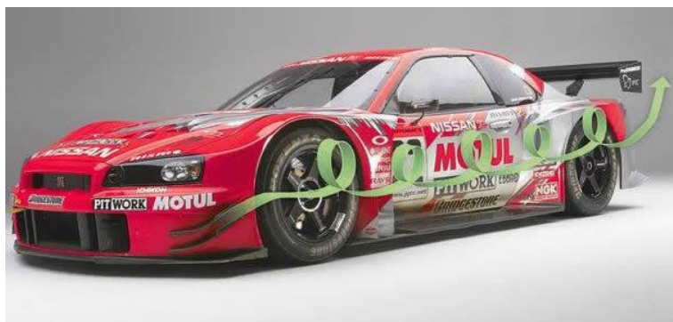
Obrázek 18: Znázornění vzniklého víru u závodního automobilu [24]
