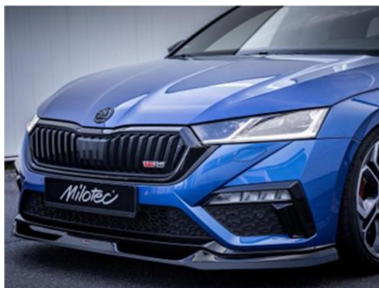
Obrázek 7: Přední splitter přidaný v rámci tuningu na Škodu Octavii IV RS. [11]
