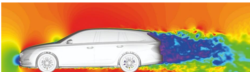
Obrázek 6: CFD simulace vozu Škoda Octavia kombi, rychlostní profil [7]
