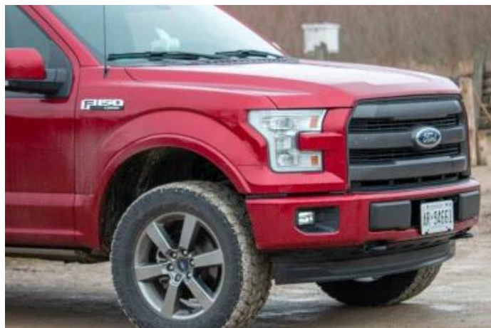
Obrázek 9: Americký pick-up Ford F150 s úpravou air dam [12]
