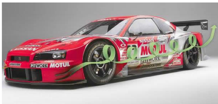
Obrázek 18: Znázornění vzniklého víru u závodního automobilu [24]
