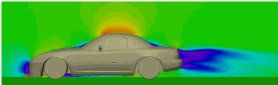
Obrázek 10: CFD simulace rychlostního profilu Mazda Miata [13]
