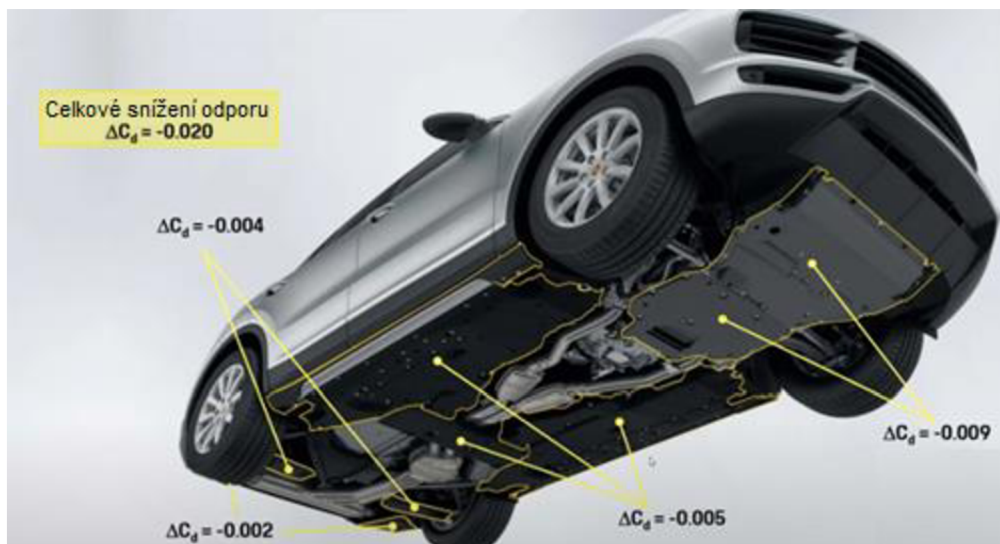
Obrázek 35: Podvozek Porsche Cayenne s vyznačenými úbytky na součiniteli odporu, upraveno dle [67]
