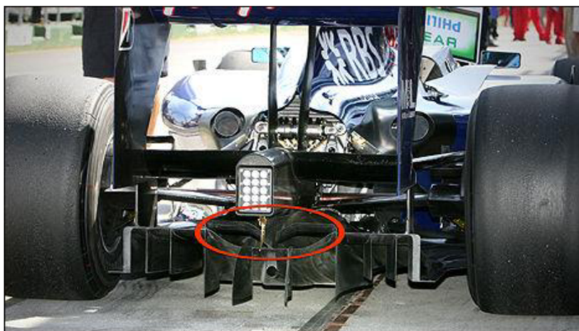
Obrázek 31: Kanál dvojitého difuzoru na voze stáje Williams [53]
