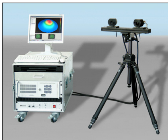
Obr. 26 Systém ARAMIS (výpočetní a snímací část) [36]
