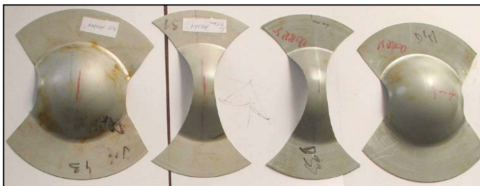
Obr. 70 Ukázka dodaných vzorků pro materiál „D“ a „V“, poloměr přístřihu b = 30 a 120 mm
