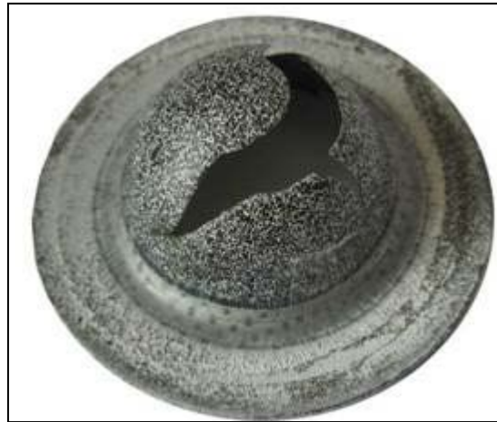
Obr. 43 Zkušební vzorek s naneseným stochastickým vzorem
