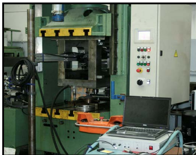
Obr. 44 Uspořádání pracoviště při snímání deformace pomocí systému ARAMIS
