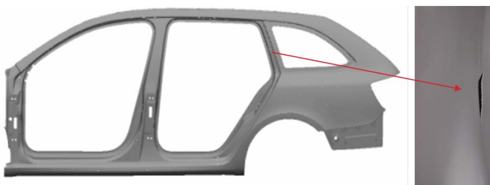
Obr. 35 Postranice vozu se znázorněným místem trhliny a samotnou trhlinou
