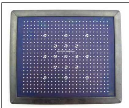
Obr. 27 Kalibrační destička určena pro kalibraci systému ARAMIS[36]
