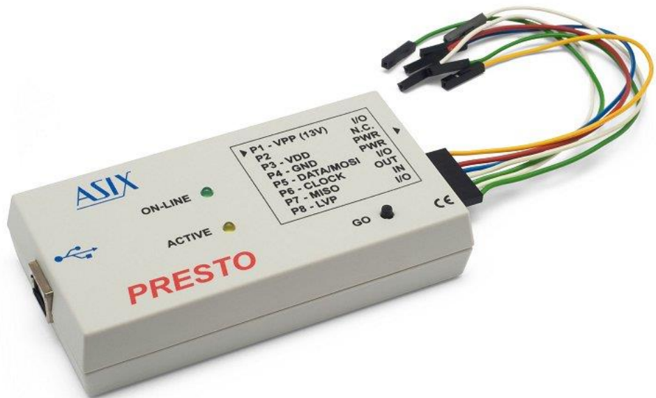
Obrázek 7.1: Programátor ASIX PRESTO s propojovacím kabelem
