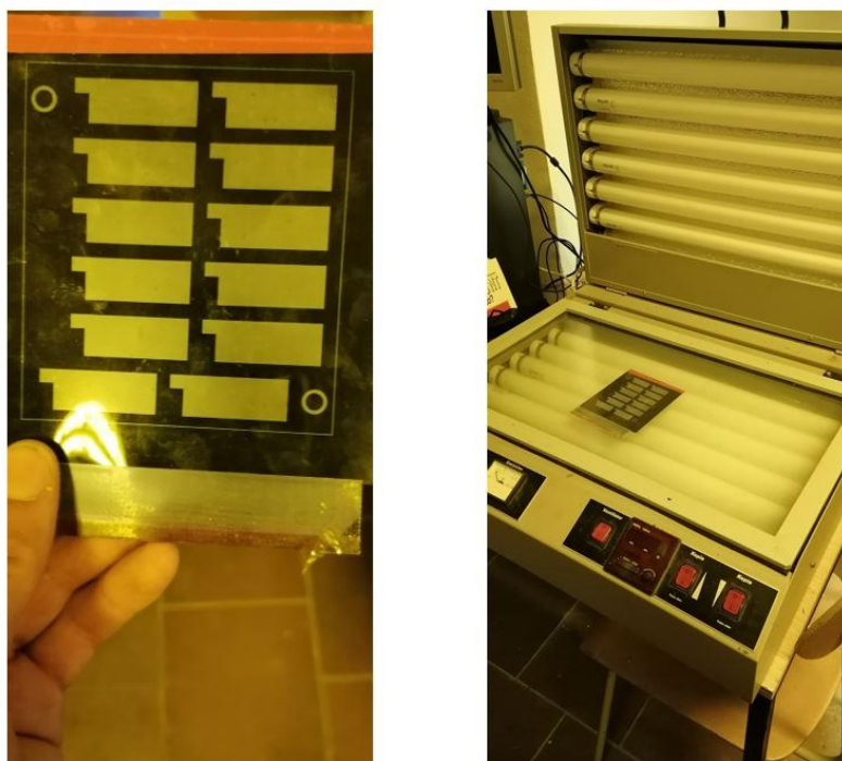
Obrázek 12 Fotomaska se založeným zalaminovaným PVDF filmem (vlevo), vakuová expoziční jednotka Hellas BUNGARD (vpravo) (Matěj Burda, 2021)
