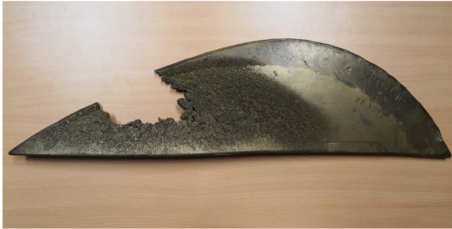
Obrázek 2 Kavitační eroze na lopatce vrtule (Peters, 2019, s. 30)
