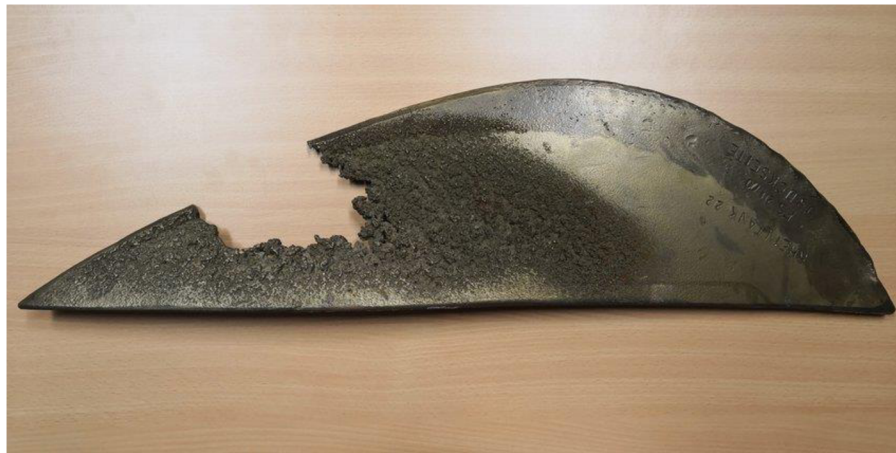
Obrázek 2 Kavitační eroze na lopatce vrtule (Peters, 2019, s. 30)
