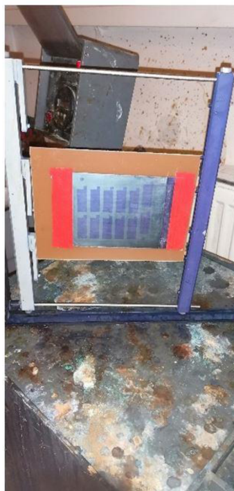
Obrázek 13 Zařízení pro proces vyvolávání (vlevo), fólie v zakladači před procesem vyvolávání (vpravo) (Matěj Burda, 2021)
