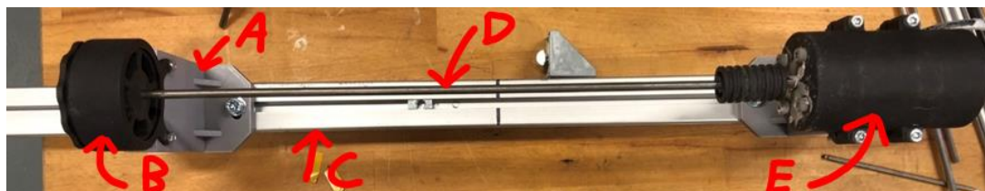
Obrázek 24: Uchycení pohonné jednotky na hliníkovém profilu A – vytisknutý držák protikusu; B – protikus pohonné jednotky; C – Hliníkový profil; D – Kolektor (vřeteno); E – pohonná jednotka
