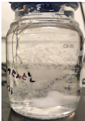
Obrázek 6: Zakalený roztok PCL v rozpouštědlovém systému rozpouštědlovém systému aceton, kyselina mravenčí, kyselina octová (1/1/1) po 24 hodinách
