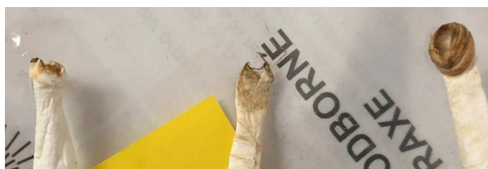
Obrázek 31: Vzorky z PLA s vrstvou rezidui z vřetene
