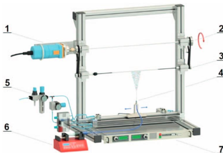
Obrázek 5: Schéma zvláknovací jednotky určené pro jehlový DC elektrospinning tubulárních vzorků [94] 1- Pohonná jednotka; 2- Převod; 3- Pozitivně nabitý kolektor; 4- Zvláknovací jehla; 5- Pneumatické ovládání pojezdu; 6- Pumpa polymerního roztoku; 7 – Zdroj vysokého napětí
