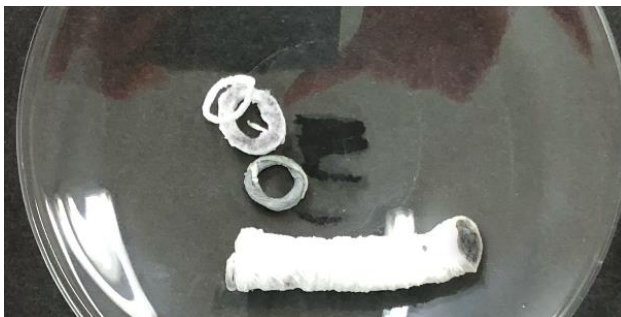
Obrázek 12: Sejmutý vzorek PA6 z kompozitního vřetene vpravo obarvená vnitřní strana
