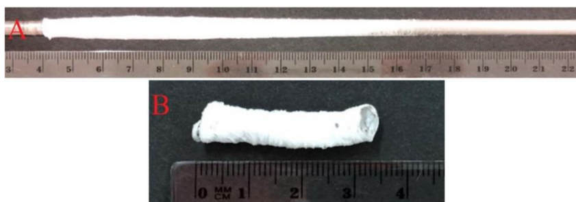
Obrázek 8: Vzorek z PA6 A – Vzorek z PA6 na vřetenu s pravítkem před sejmutím; B – Sejmutý a sražený vzorek z PA6
