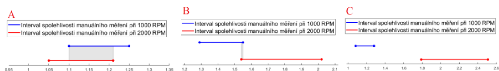
Obrázek 40: Schéma vyhodnocování překrytí intervalů spolehlivosti A – Intervaly se silně překrývají; B – Intervaly se částečně překrývají vysoké riziko chyby; C – Intervaly se nepřekrývají
