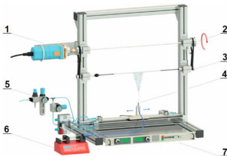
Obrázek 5: Schéma zvláknovací jednotky určené pro jehlový DC elektrospinning tubulárních vzorků [94] 1- Pohonná jednotka; 2- Převod; 3- Pozitivně nabitý kolektor; 4- Zvláknovací jehla; 5- Pneumatické ovládání pojezdu; 6- Pumpa polymerního roztoku; 7 – Zdroj vysokého napětí
