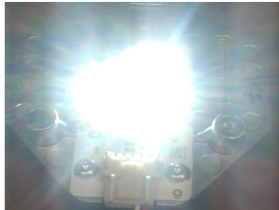
Obr. 37: Úroveň jasu při 99% střidy řídicího signálu
