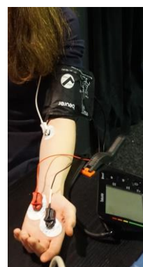
Obrázek 6: Nákres umístění elektrod k měření EDA na levé ruce (vlevo) a zapojení elektrod k měření EDA a tlakoměru (vpravo)
