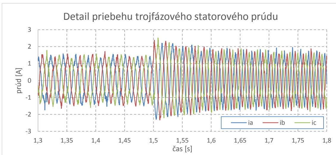
Obrázok 27: Detail priebehu trojfázového satorového prúdu
