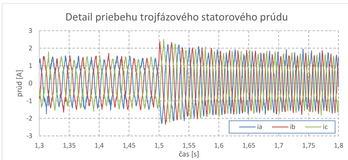
Obrázok 27: Detail priebehu trojfázového satorového prúdu
