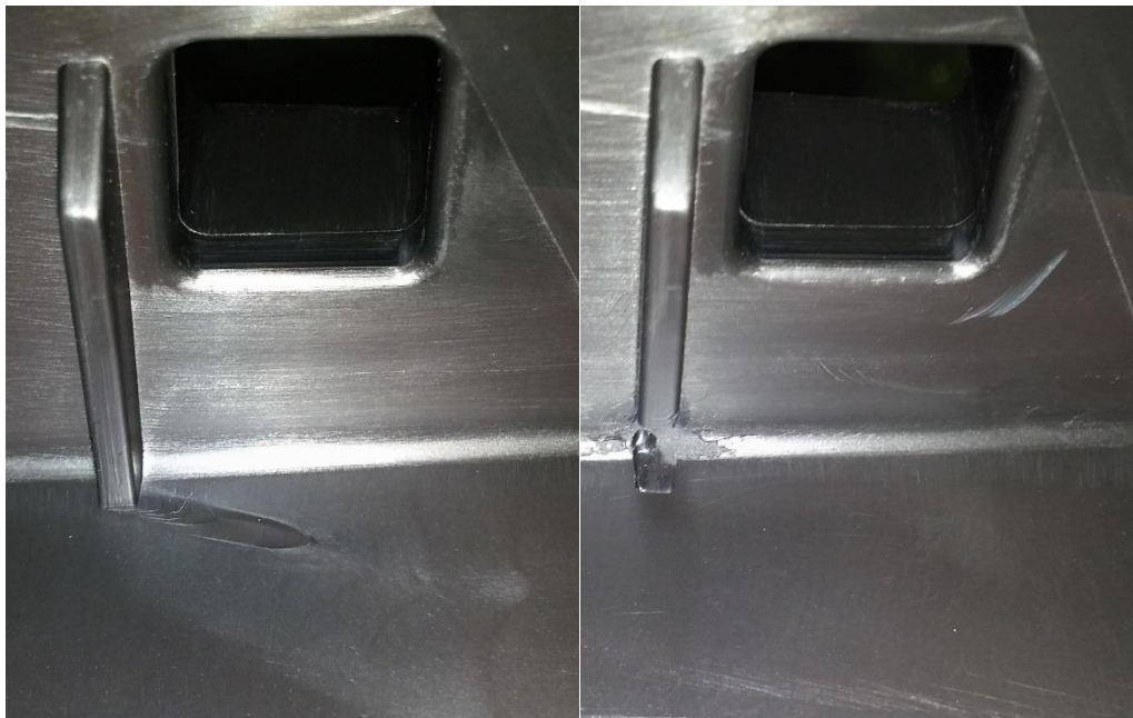
Obr. 4.45: Vlevo turbulence od žebra, vpravo bez turbulencí s provizorně přerušeným žebrem
