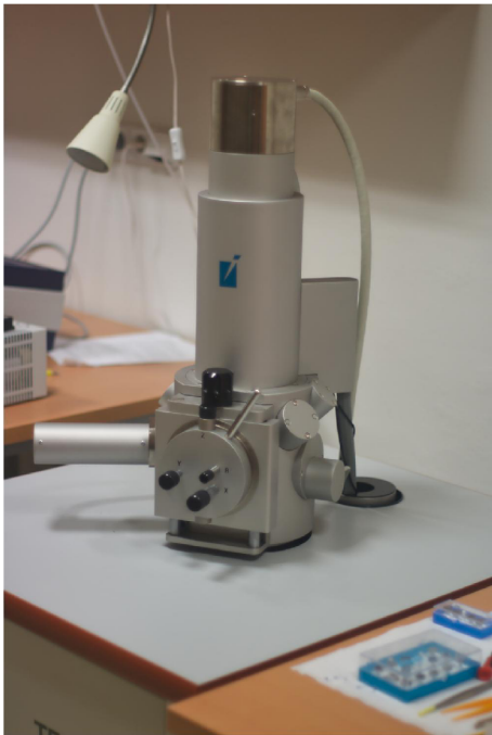
Obrázek 4.3 vlevo - elektronový mikroskop VEGA II, vpravo - držák vzorků pro litografii.
