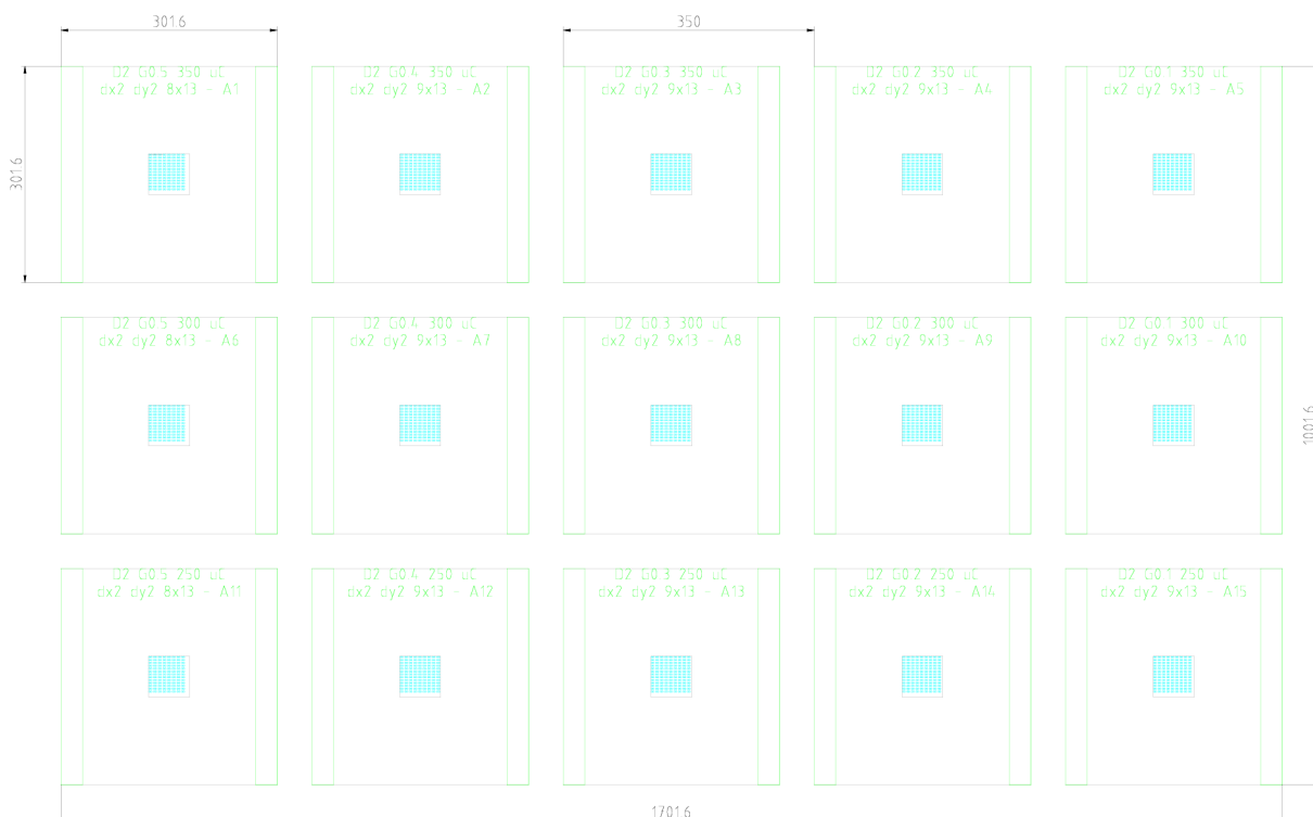
Obrázek 6.1 Rozložení polí na vzorku, D - průměr antény v \mu\text{m} , G - velikost gapu mezi anténami v \mu\text{m} , dx, dy - rozestupy mezi dvojicemi antén v \mu\text{m} , kóty jsou taktéž v \mu\text{m} .
