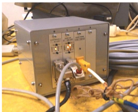
Obr. 49 Zadní strana modulu se zapojenými měřicími prvky
