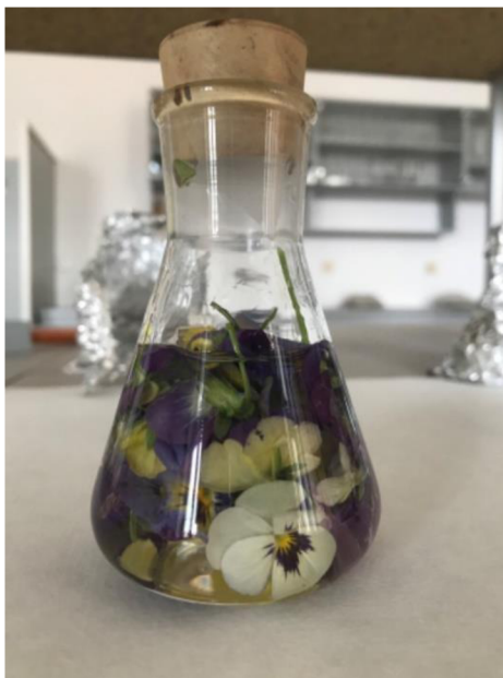
Obrázek 16: Uzavření vzorku v Erlenmayerově baňce s 80 ml 60% methanolu (zdroj: vlastní foto)
