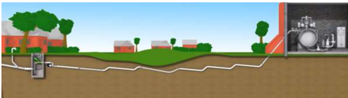
Obr. 6 Podtlaková kanalizace (www.miper.gr)
