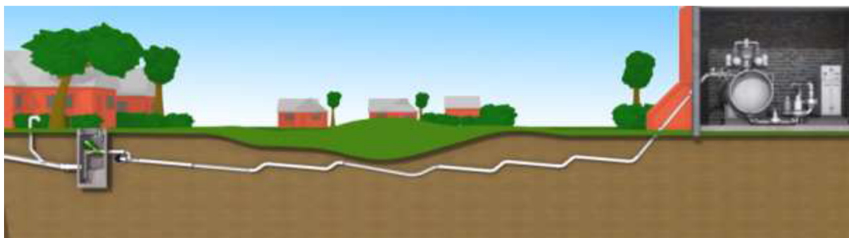
Obr. 6 Podtlaková kanalizace ( www.miper.gr )
