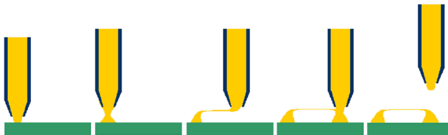
Obr. 3: Schématický princip metody Drawing [7]
