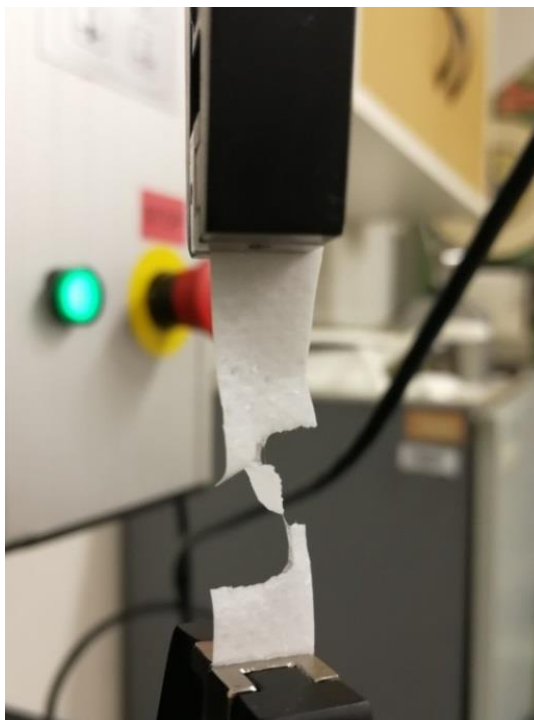
Obr. 17: Vlákenný materiál umístěný mezi dvěma čelistmi po trhacím testu, kdy došlo k přetržení
