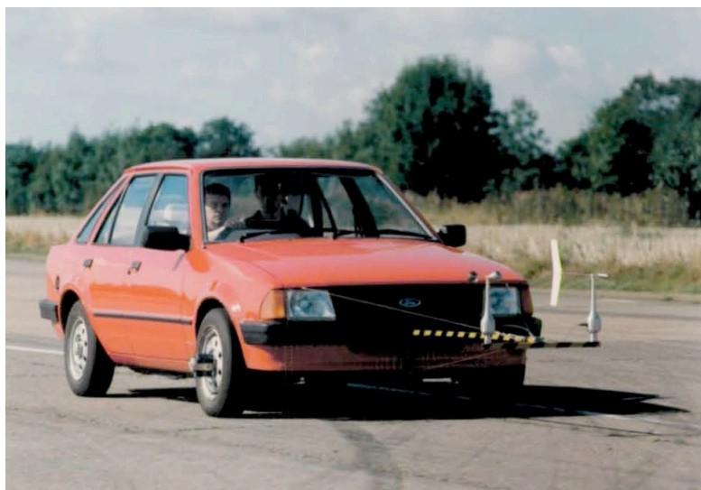
Obr. 10 Ford Escort 1300L používaný pre meranie odporov s anemometrom a meračmi momentu hnaných kolies [9]
