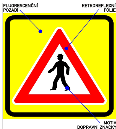
Obr. 24 Dopravní značka s fluorescenční retroreflexní fólií
