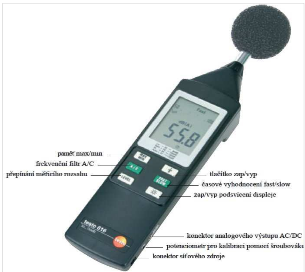
Obr. 19 Hlukoměr testo 816 a jeho popis tlačítek
