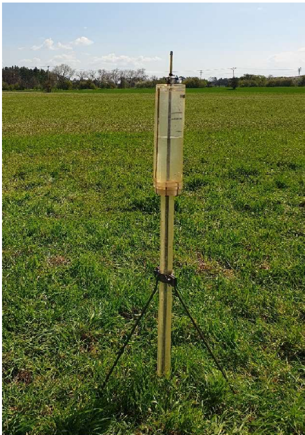
Obrázek 3.: Guelphský permeametr na lokalitě Zvěřinec a ošetření s hnojem při dubnové kampani (fotografie pořízena autorem práce, 21.4.2023).
