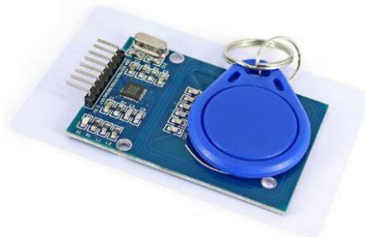
Obr 18: RFID čtečka s vestavěnou anténou
