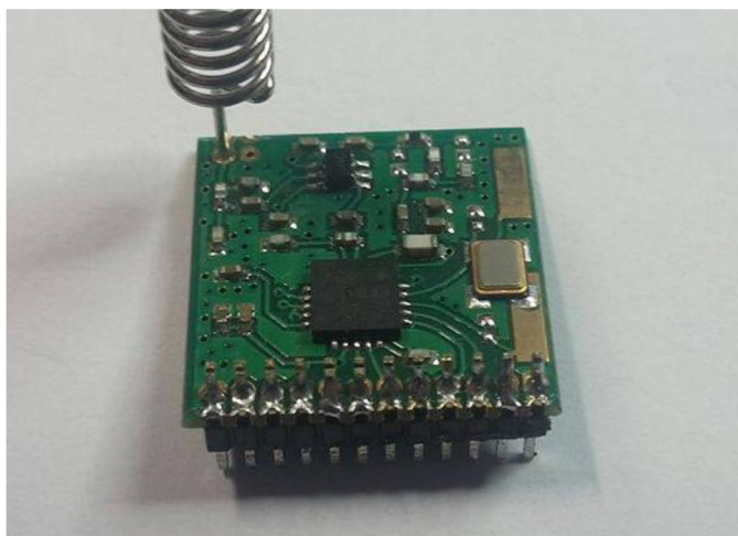
Obr.8: Bezdrátový modul DRF4432F20
