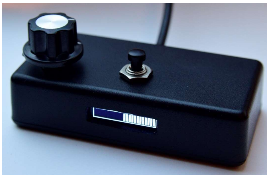
Obr. 7.7 Hotový digitální ovladač hlasitosti
