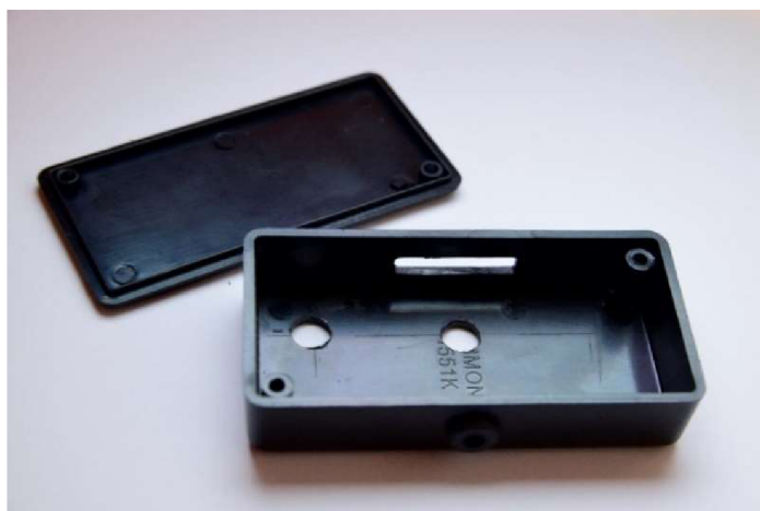
Obr. 7.5 Krabička Hammond Manufacturing 1551KBK s připravenými otvory.
