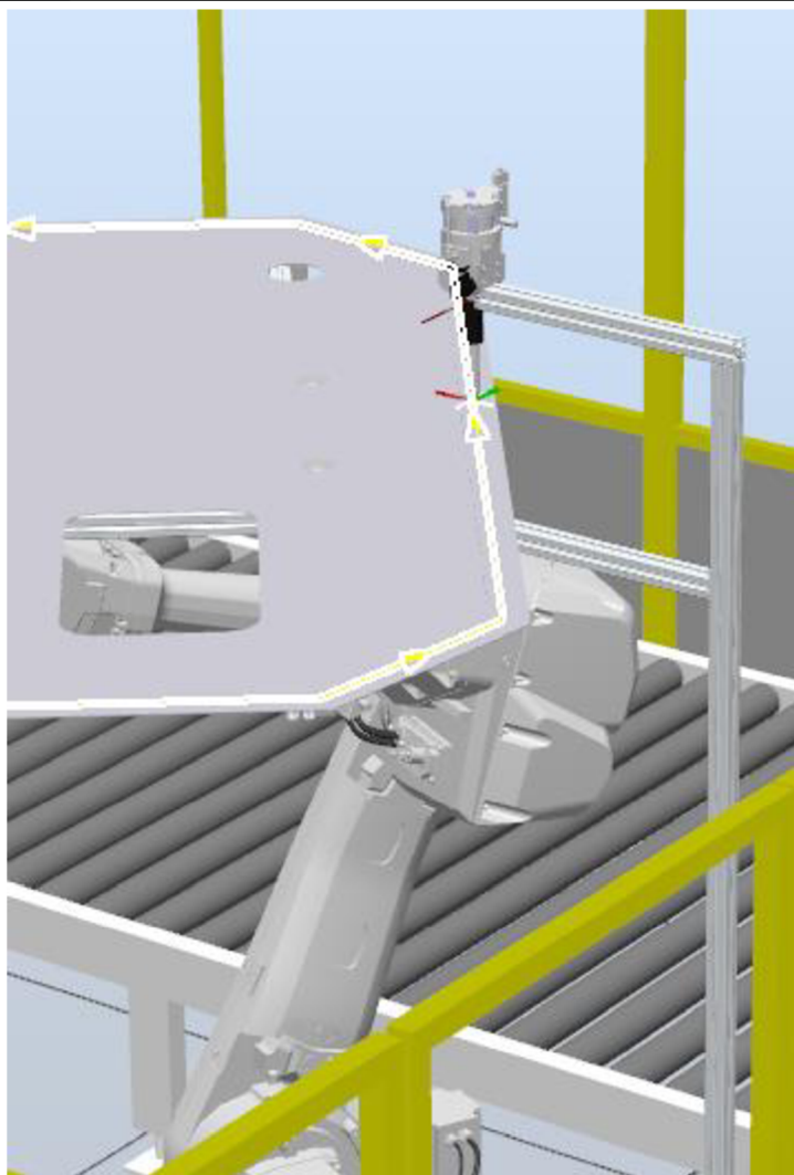
Obr. 15) Robot pri nanášaní tesniaceho tmelu
