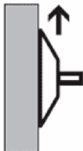
Obr. 13) Prísavka v zvislej polohe, pohyb v zvislom smere (najmenej priaznivý prípad)[19]
