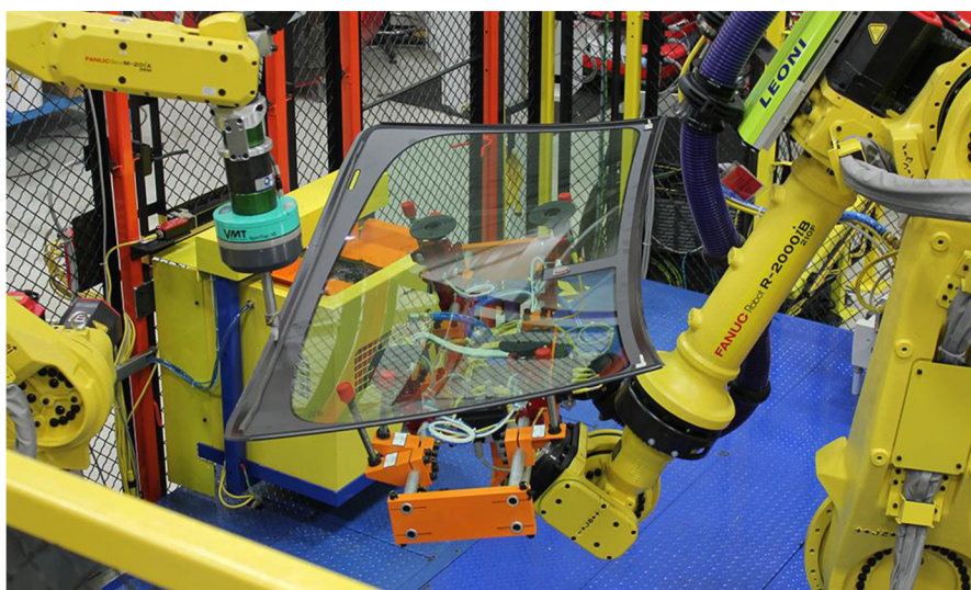
Obr. 8) Robotizované nanášanie lepidla na čelné sklo automobilu [9]
