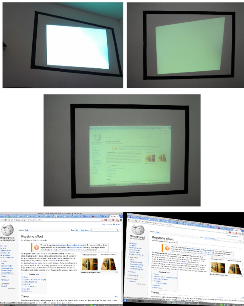
Obrázek A.1: Příklad projekce dovnitř plátna. Nahoře se nachází nezkalibrovaný obraz. Vlevo je obraz z webkamery, vpravo z digitálního fotoaparátu. Uprostřed je obraz již kalibrován. Dole se nachází porovnání výstupu displeje a projektoru.
