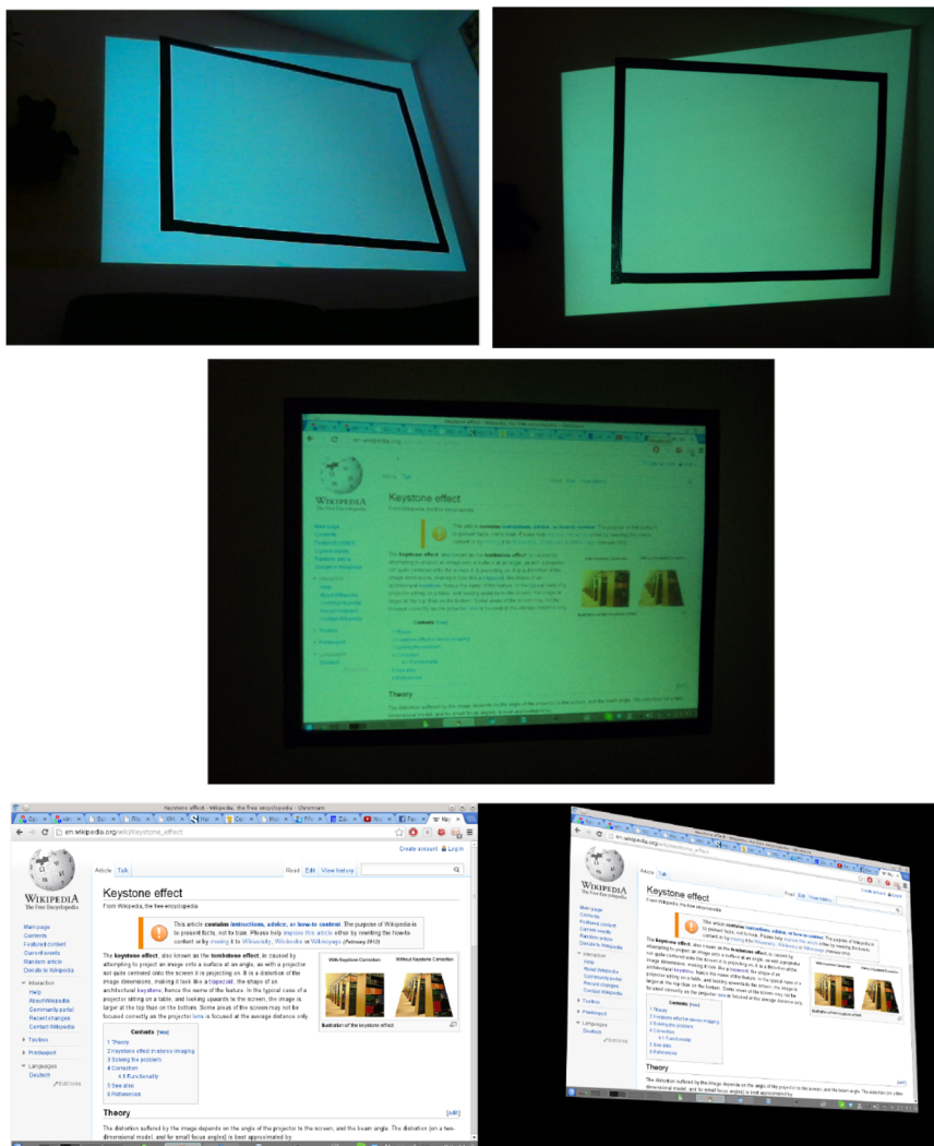
Obrázek A.2: Příklad projekce vně plátna. Nahoře se nachází nezkalibrováný obraz. Vlevo je obraz z webkamery, vpravo z digitálního fotoaparátu. Uprostřed je obraz již kalibrován. Dole se nachází porovnání výstupu displeje a projektoru.
