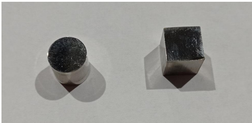
Obr. 3.2.1 Materiály po nanesení povlaků; vlevo AISI 316L, vpravo AISI 304
