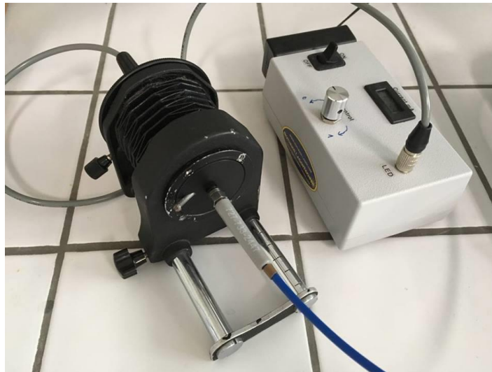
Obrázek 7 Měření intenzity UV LED zdroje světlotěsným měchem
