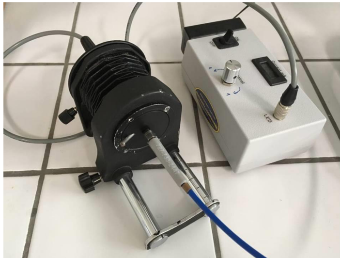
Obrázek 7 Měření intenzity UV LED zdroje světlotěsným měchem
