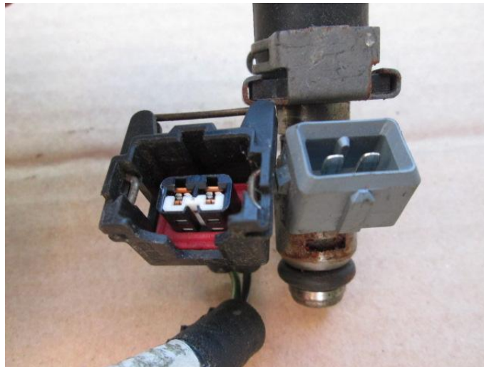
Obr. 2.4: Aplikace poka yoke na konektor vstřikovače u motoru automobilu.
