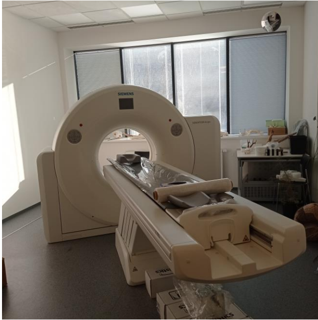
Obrázek 7 Počítačový tomograf Siemens Somatom Scope Power, VC 40 umístěný v High-tech pavilonu FLD ČZU (autor: T. Širlová).
