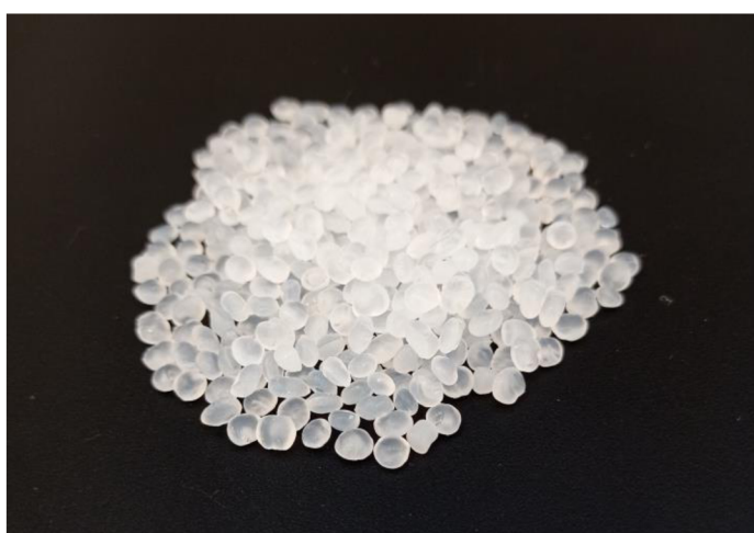
Obrázek 6 Měrné medium pro mechanickou volumetrii, polymerní granulát LDPE Exxonmobil LD 650, průměr granulí 2–3 mm (autor: T. Širlová).
