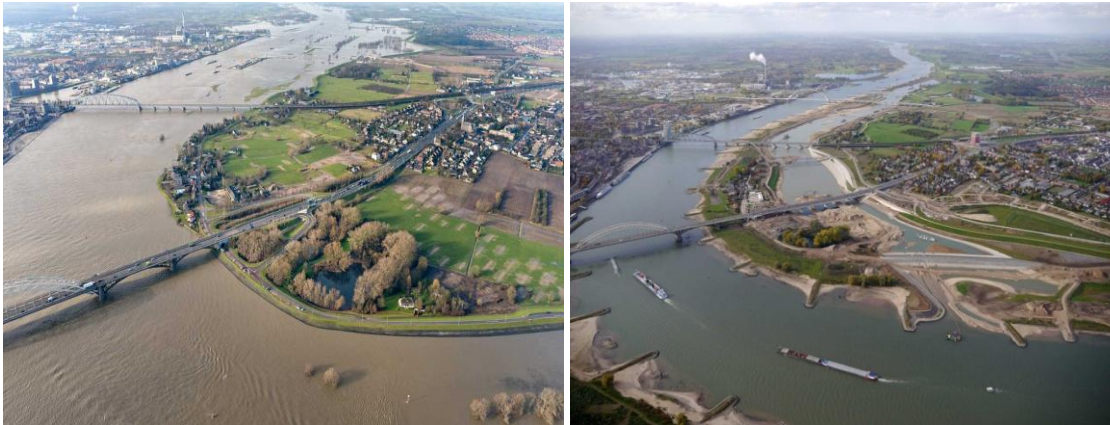
Obrázek 8 a), b): řeka Waal v Nijmegen: a) území řeky před provedenými úpravami (zdroj: landezine.com, 2016), b) území řeky po provedení protipovodňových opatření (zdroj: landezine.com, 2016).
