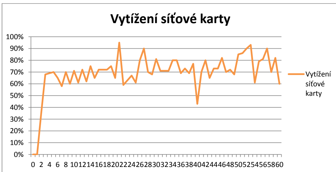
Graf 10 Grafické znázornění vytížení síťové karty během šifrování velkého souboru nástrojem Boxcryptor. (Zdroj: vlastní zpracování dle grafu z aplikace Sledování prostředků)
