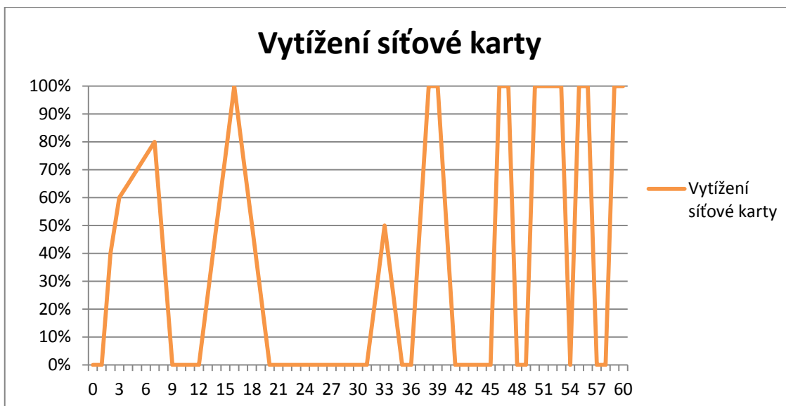
Graf 8 Grafické znázornění vytížení síťové karty během šifrování velkého množství malých souborů nástrojem AxCrypt. (Zdroj: vlastní zpracování dle grafu z aplikace Sledování prostředků)
