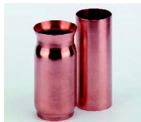
Obr. 2.13 Příklad výtvaru tvářeného radiálním vypínáním [5]
