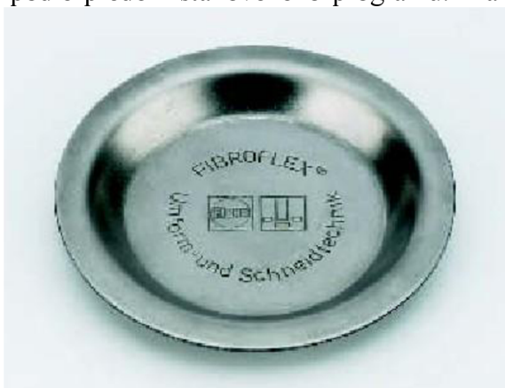
Obr. 2.6 Výtažek tvářený metodou Marform v kombinaci s ražením [5]
