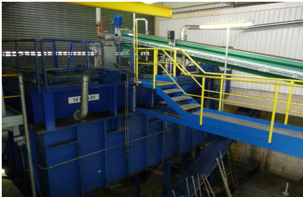
Obrázek 10- Šnekový dopravník N 104 solidifikovaného kalu do zásobníku H 08.001 na T 700 Unipetrol RPA s.r.o.
