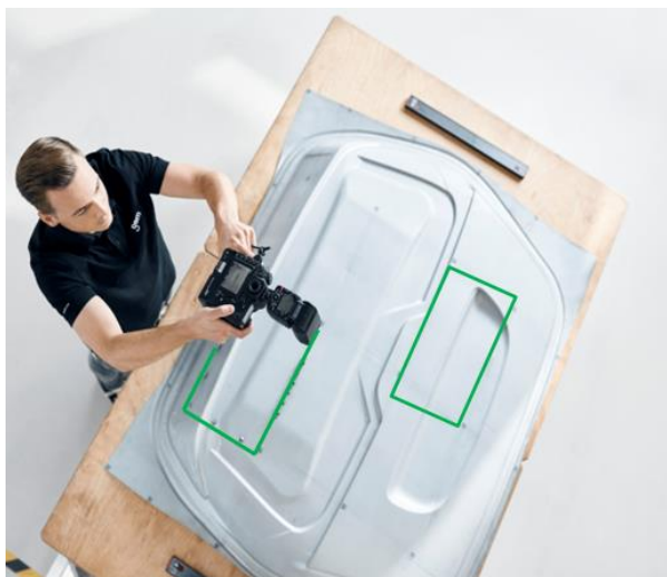
Obr. 4: Ilustrace měření výlisku ruční kamerou [18]
