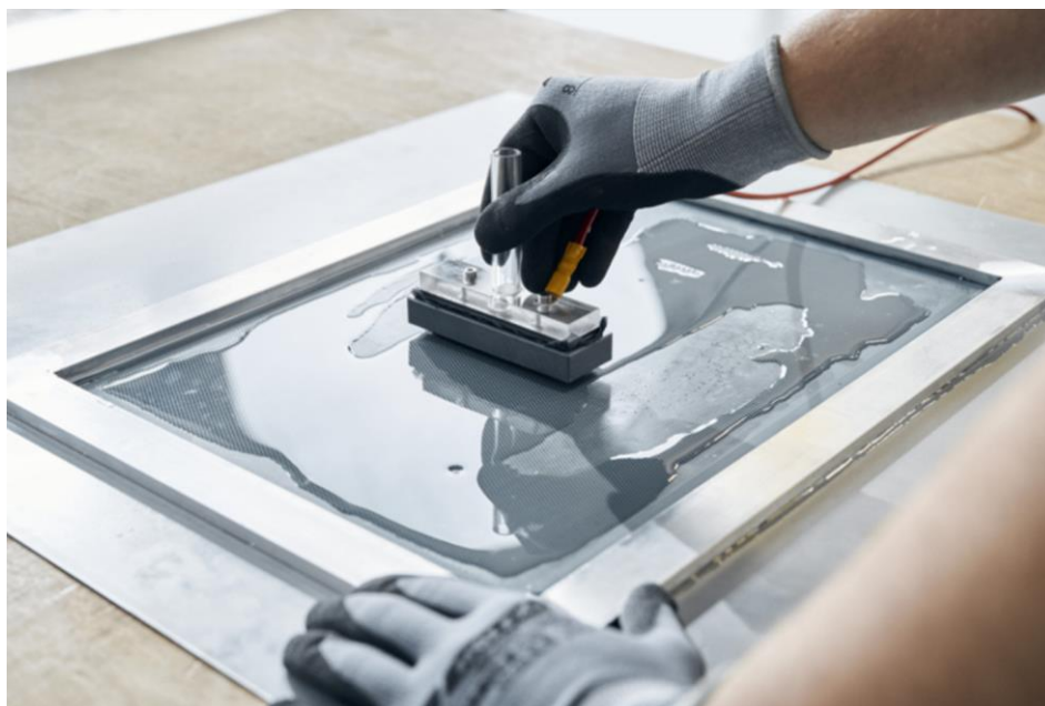
Obr. 9: Ilustrační obrázek nanášení elektrochemicky leptané sítě. [18]
