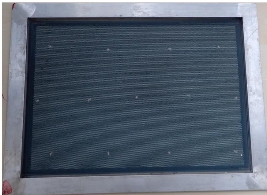
Obr. 12: Šestiúhelníková síť pro elektrochemické leptání.
