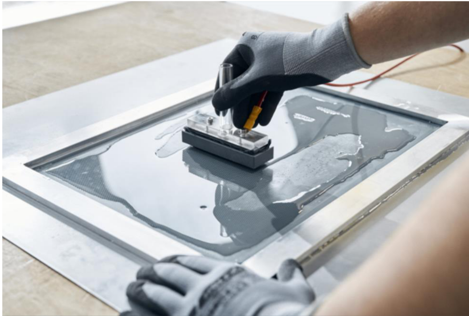
Obr. 9: Ilustrační obrázek nanášení elektrochemicky leptané sítě. [18]
