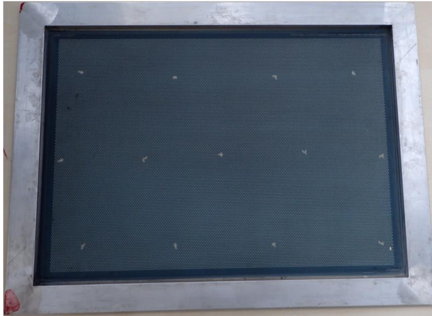
Obr. 12: Šestiúhelníková síť pro elektrochemické leptání.
