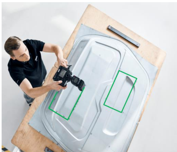
Obr. 4: Ilustrace měření výlisku ruční kamerou [18]
