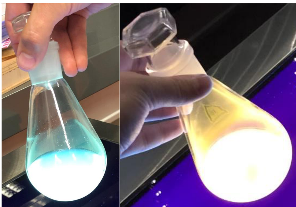
Obrázek 39: Růst nanočástic ZnO získaného klasickou syntézou pod UV lampou.
