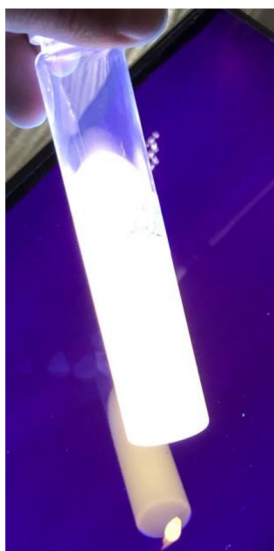
Obrázek 27: Koloid získaný MW syntézou pod UV lampou.
