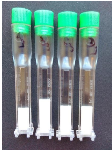
Obrázok 28: Vzorky v kvetách pripravené na stanovenie stability pomocou analytickej centrifúgy
