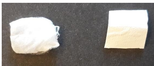
Obrázok 16: Porovnanie vlákien: vľavo vlákno pripravené pomocou forcespinningu, vpravo vlákno pripravené pomocou electrospinningu
