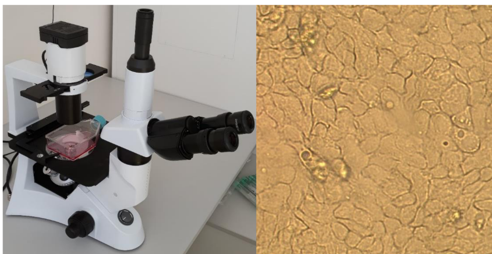
Obrázok 21: Vľavo – inverzný mikroskop s kultivačnou nádobou, vpravo – ľudské keratinocyty pri zväčšení 200×
