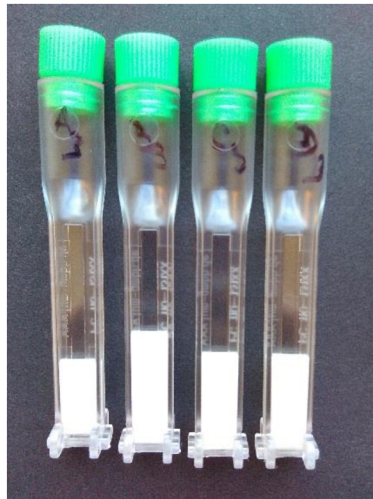
Obrázok 28: Vzorky v kyvetách pripravené na stanovenie stability pomocou analytickej centrifúgy
