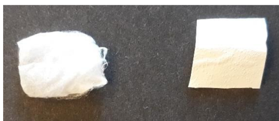
Obrázok 16: Porovnanie vlákien: vľavo vlákno pripravené pomocou forcesspinningu, vpravo vlákno pripravené pomocou elektrosinpingu
